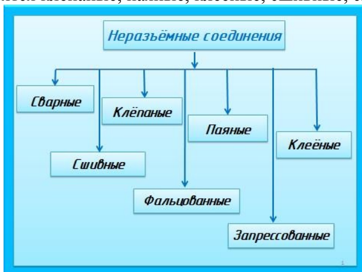
Рис. 114. Основные виды неразъемных соединений
